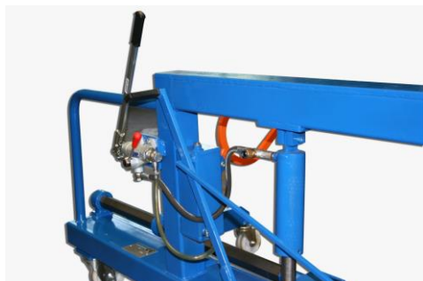
Sollevamento subbio con pompa idraulica manuale
